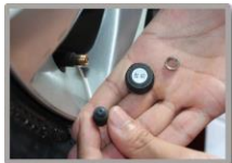
Sensor mit Ventilkappe austauschen
