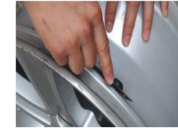
Alte Ventil abschneiden
