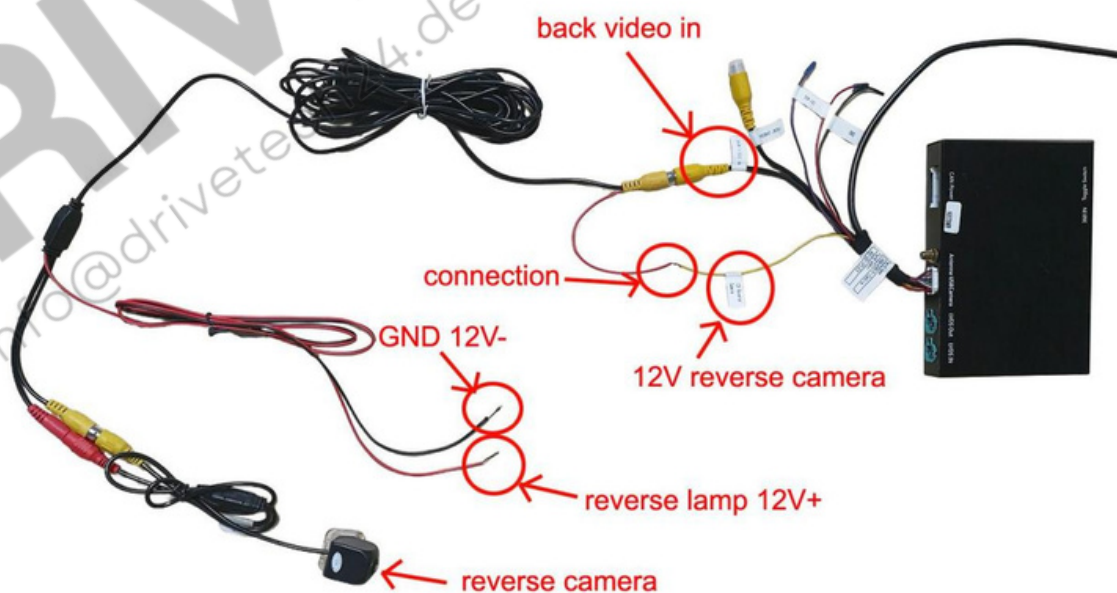
Kabelanschluss für Aftermarket-Rückfahrkamera
